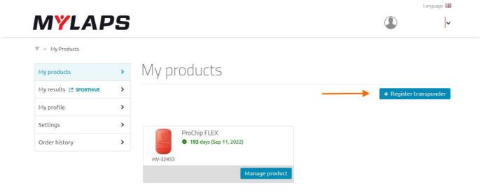
Adesso inserite il codice del transponder composto da due lettere e da cinque numeri e collegate fisicamente il vostro transponder alla presa USB del PC.
